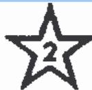
Tension d'épreuve 2 kV eff. 50 Hz
